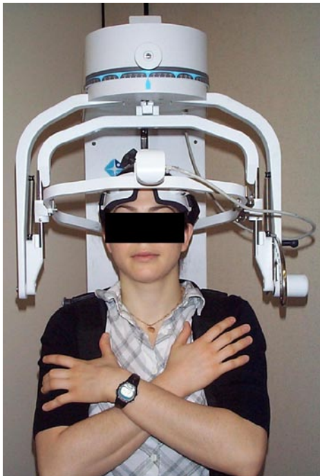
Figure 1 : Le Multi-Cervical Unit (MCU, BTE technologies, Inc. TM , 2006) en position pour le test de flexion.
